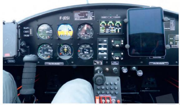
L'instrumentation est signée Kanardia. Elle comporte un badin, un altimètre, un compte-tours, un variomètre, et un mini-EFIS en double exemplaire (ici, l'un affiche l'horizon artificiel, l'autre le compas). Sur la droite, un EMS concentre tous les paramètres moteur.
